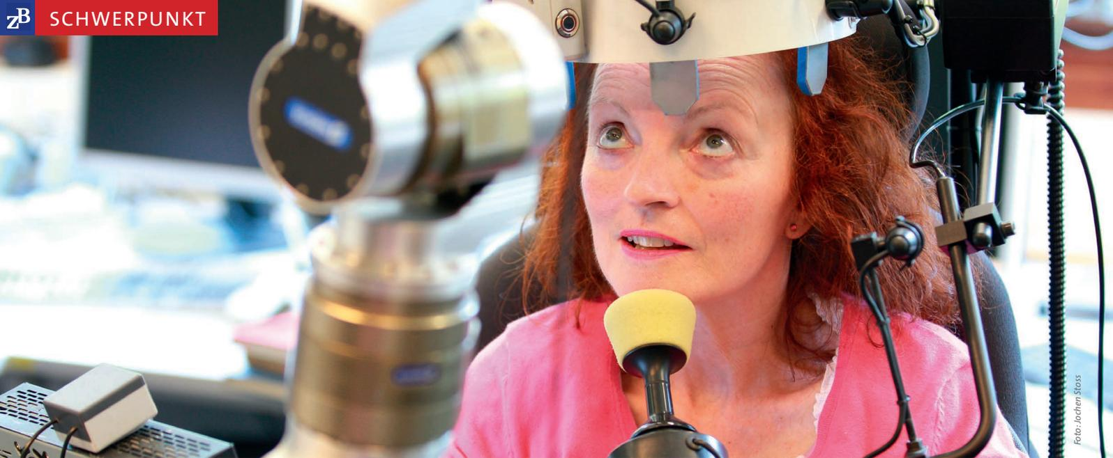
Im Rahmen eines Forschungsprojektes an der Universität Bremen testet Lena Kredel, die vom Hals abwärts fast völlig gelähmt ist, einen Roboter-Assistenten. Seinen Greifarm steuert sie mit einem Kinn-Joystick.
